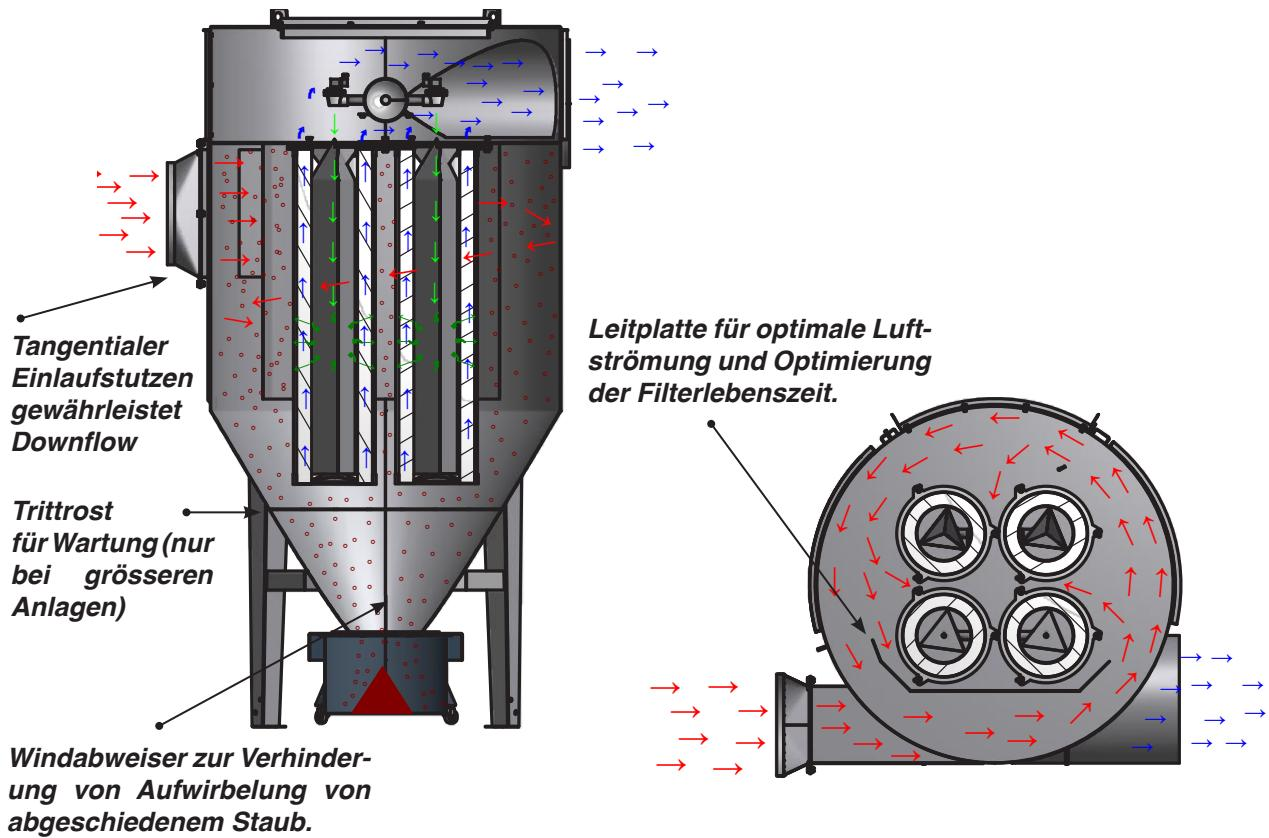
Prinzipskizze für Flow durch Zyklonfilter Typ ACF-T:
