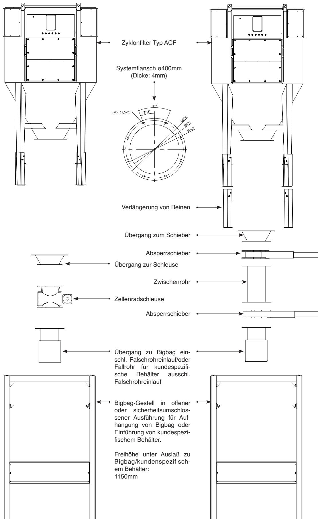
Zyklonfilter Typ ACF/ACF-T/ACF-V ist erhältlich in den Größen, die im Schema unten angezeigt werden.
